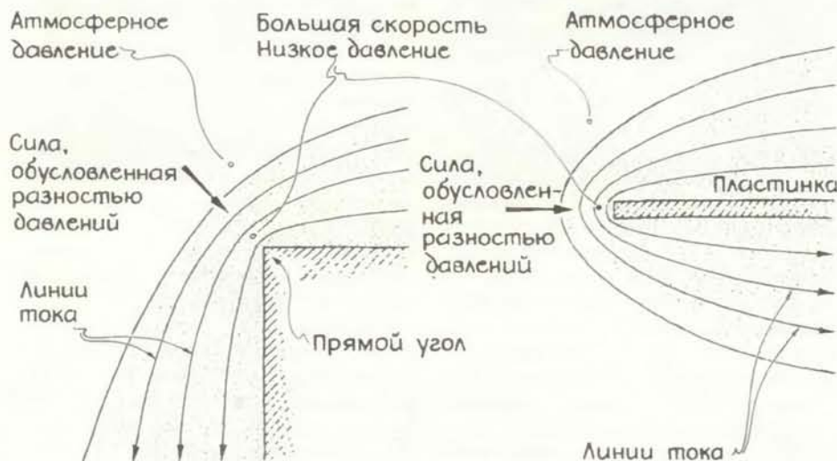
Линии тока вблизи краев двух разных видов
